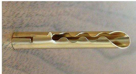
Die **Bananenstecker** sind aus einer speziellen Beryllium-Kupfer Legierung gefertigt und anschließend vergoldet. Das Beryllium gibt dem Kupfer die notwendige Federkraft, die benötigt wird um in Verbindung mit einer Buchse einen hohen Anpressdruck und damit einen sicheren Kontakt zu gewährleisten. Die akustischen Vorzüge von Kupfer bleiben hierdurch weitgehend unberührt.
